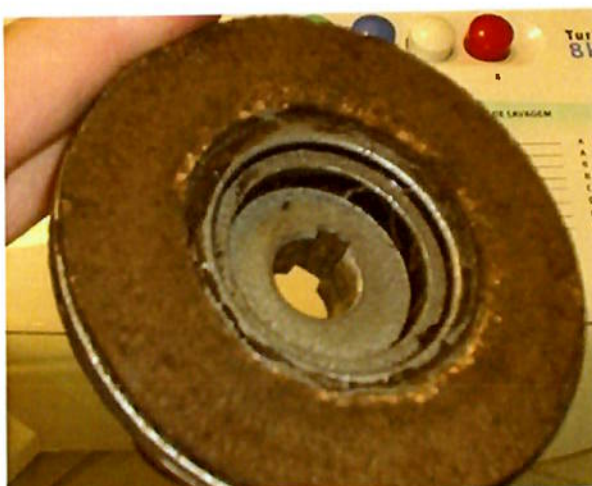
Fig. 25 – Disco de fricção gasto
