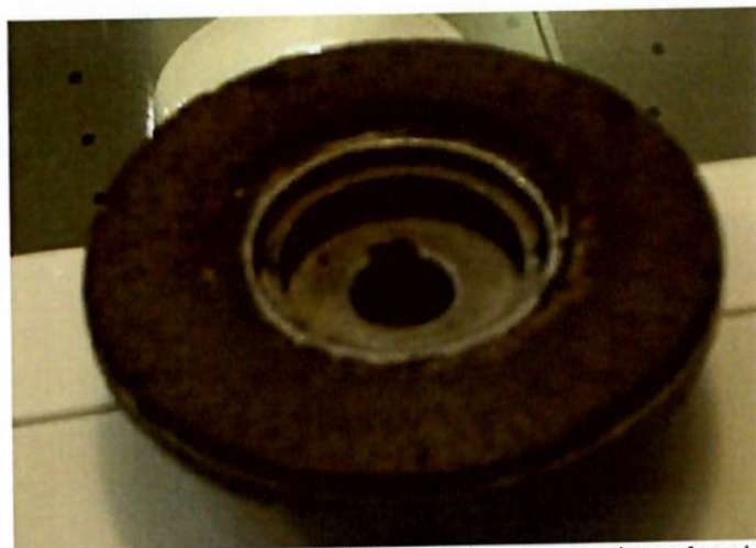
Fig. 15 – disco de fricção gasto devido ao acionamento desenfreado da porta
