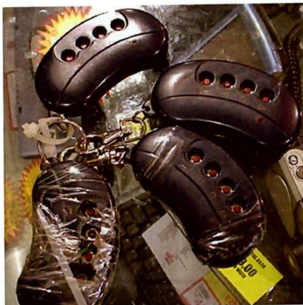
Fig. 26 - controles danificados, devido ao manuseio
